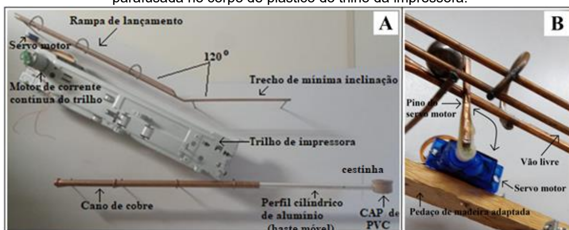
Figura 3: A) Fixações de trilho da rampa, trilho da impressora e da haste móvel do alvo (cestinha); B) Vista ampliada do servomotor com seu pino no vão livre do trilho, segurando a esfera. Optou-se por parafusar o servomotor num pequeno pedaço de madeira então parafusada no corpo de plástico do trilho da impressora.
